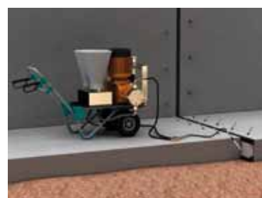
Герметизация деформационных швов
